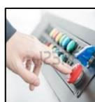
Verificar la ausencia de energía o energías en el equipo, máquina, proceso o sistema antes de iniciar la intervención o inspección a través del uso de detectores de tensión de energía eléctrica, o pulsar las botoneras de tableros de accionamiento, intentar girar válvulas, etc.
