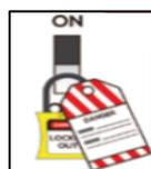
Señalar a través de la colocación de tarjetas en los puntos de bloqueo a fin de advertir a otros que el equipo, máquina, proceso o sistema está siendo intervenido.
