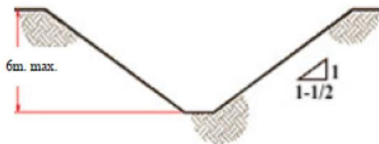
TALUD SIMPLE TIPO DE SUELO C
