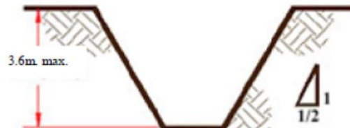
TALUD SIMPLE – TIEMPO CORTO* TIPO DE SUELO A
