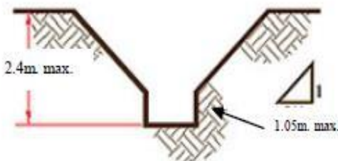
PORCION MAS BAJA VERTICALEMENTE CON TALUD SIN SOPORTE TIPO DE SUELO A
