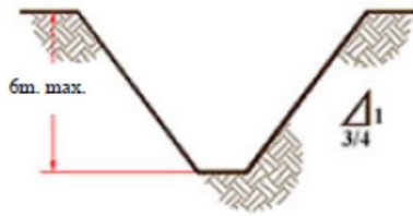
TALUD SIMPLE – GENERAL TIPO DE SUELO A
