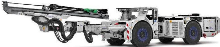
**Fig. 2 Jumbo de Perforación Radial**
