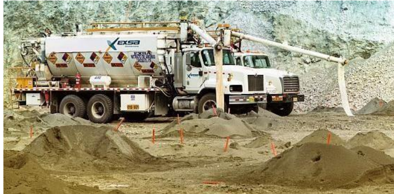
Fig. 2 Camión y equipo para carga de ANFO en operación minera subterránea
